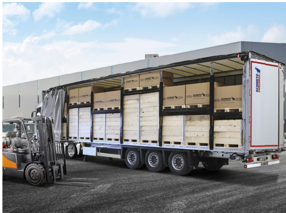
Variable Laderaumnutzung mit insgesamt 67 Palettenstellplätzen. Beim S.CS MEGA max. 3.050 mm nutzbare Innenhöhe.
