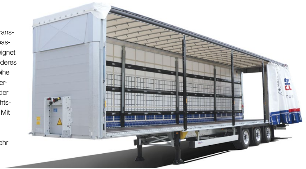
Weniger Eigengewicht – mehr Effizienz: S.CS MEGA mit POWER CURTAIN – 400 kg mehr Nutzlast als ein Standard MEGA Auflieger.
