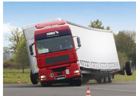
In Fahrtests werden die Aufbauten zertifiziert. Vorab testen wir die Belastbarkeit mit Hydro-pulsern im Schmitz Cargobull Validation Center.
