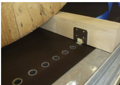
Bodenhülsen vereinfachen die Ladungssicherung, z. B. bei Kabeltrommeln.*
