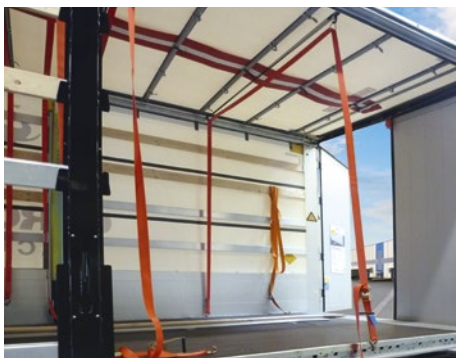
Sliding Lashing-System: Über das Dach geführte Zurrgurte lassen sich flexibel positionieren und vom Fahrer ohne Hilfe schneller spannen.
