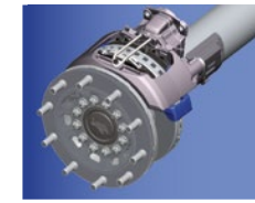
Leichter Achskopf mit 19,5" Bremsscheibe.
