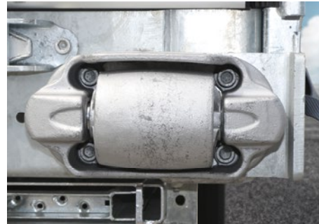
Kompressible Rollenrampuffer schützen den Heckwandrahmen beim Andocken an die Laderampe.
