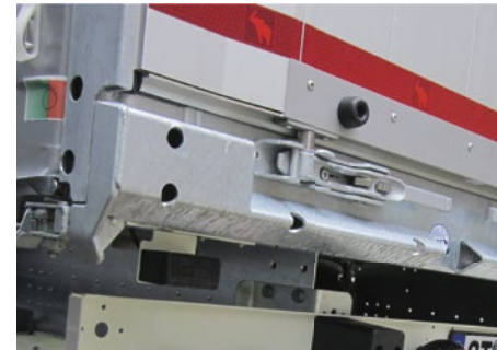
Je nach Einsatzzweck gibt es Gummirampuffer, Stahl-Rampuffer oder die kompressible Rolle.
