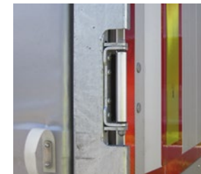
Heckportal-Eckprofile mit integriertem Rammenschutz für die Scharniere in ganzer Höhe.
