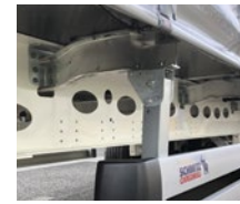
X-LIGHT Chassis mit Aluminium-Bauteilen.
