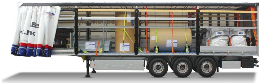
Sliding Lashing-System: Über das Dach geführte Zurrgurte lassen sich flexibel positionieren und vom Fahrer ohne Hilfe schneller spannen.
