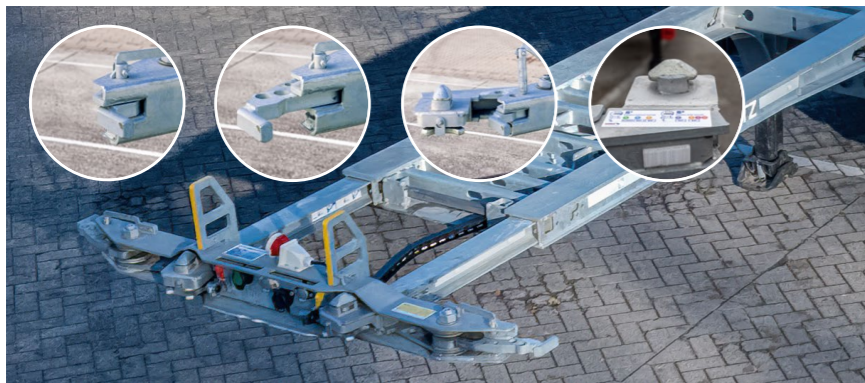
MULTI LOCK am Frontbalken in den Verriegelungspositionen für Tunnelcontainer mit schrägen Ecken, geraden Ecken und für Container ohne Tunnel, mit zwangsgeführter Stecksicherung.
